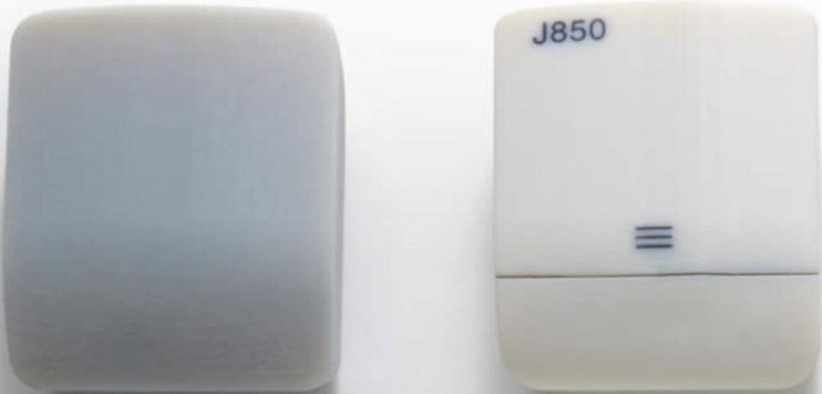
Prototypen von Ohrhörergehäusen, 3D-gedruckt mit DraftGrey (links) und VeroPureWhite (rechts)
